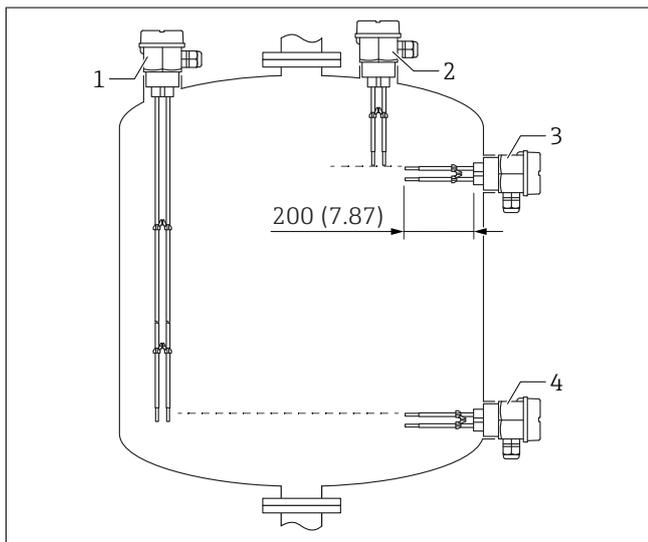
1 Posizioni delle sonde ad asta nel serbatoio
