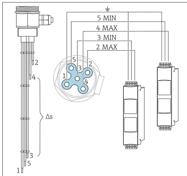
3 Connessione del campione di una sonda a cinque aste a due unità di elaborazione dati
