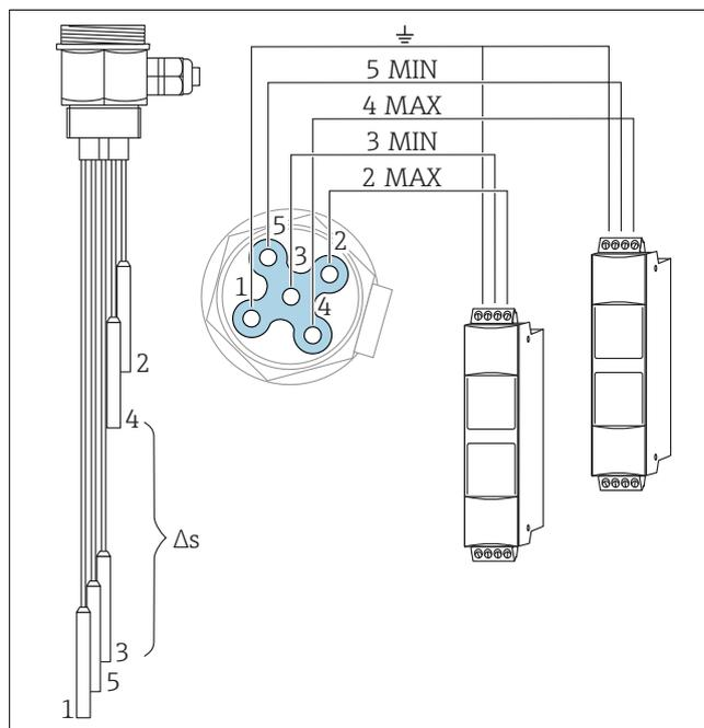
3 Exemple de raccordement d'une sonde à cinq câbles à deux unités d'exploitation
