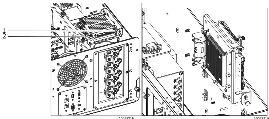
Figura 37: Visión general de la parte posterior con la placa del controlador en la posición abierta
