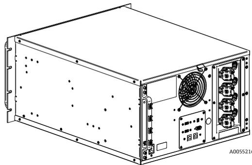
Figura 32: Colocación del Raman Rxn4 en horizontal sobre una mesa
