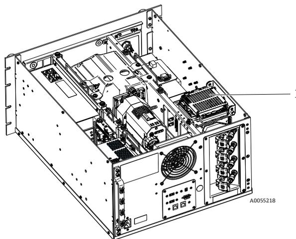
Figura 35: Visión general de la parte posterior con la placa del controlador en su posición normal (1)
