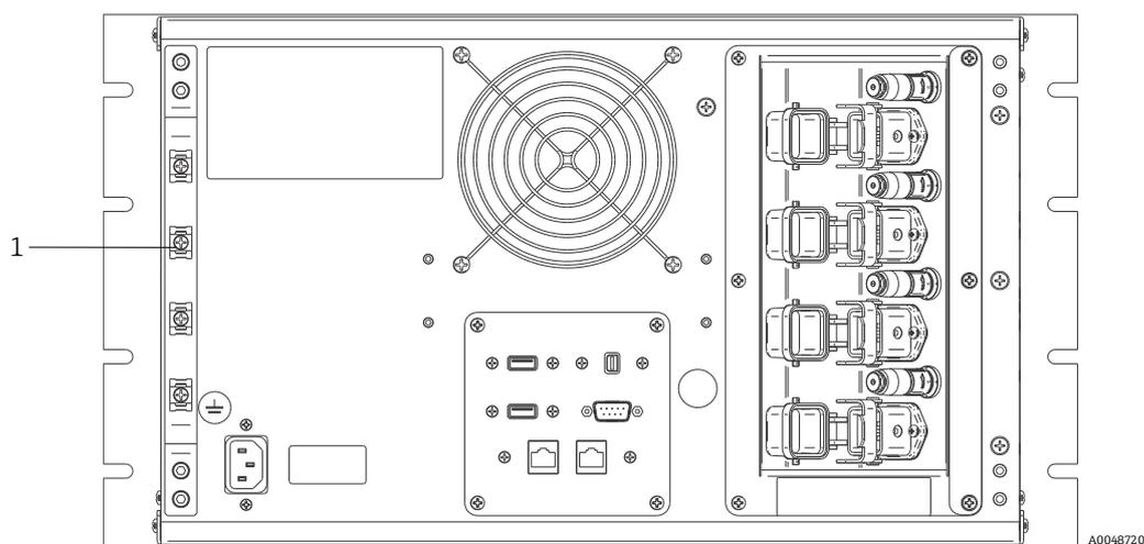
Figura 8: Barra de alivio de esfuerzos mecánicos de la fibra EO en la configuración multicanal del Rxn4
