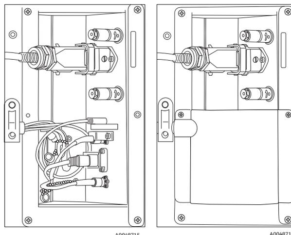
Figura 16: Antes y después de reinstalar la cubierta del canal Rxn-20
