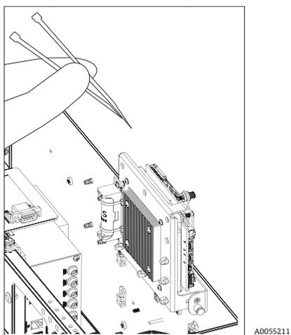
Figura 39: Sujeción de la batería nueva con bridas para cables
