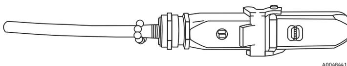
Figura 4: Conexión de fibra electro-óptica con cubierta
