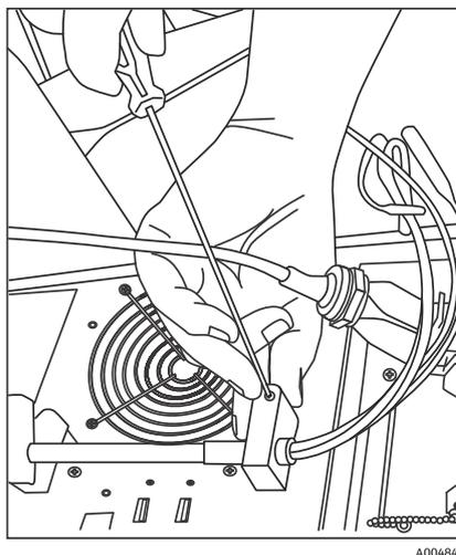
Figura 10: Emplear las dos guías de fibra para fijar el conjunto de fibra en el canal Rxn-20
