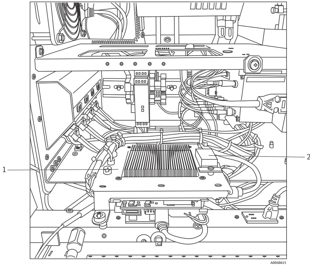
Figura 24: Controlador integrado bloqueado en la posición de servicio
