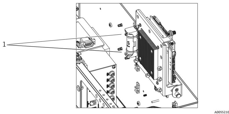
Figura 38: Retire las bridas para cables que sujetan la batería (1)
