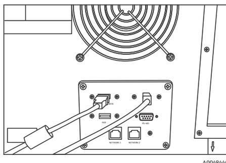
Figura 3: Conexiones del indicador con pantalla táctil
