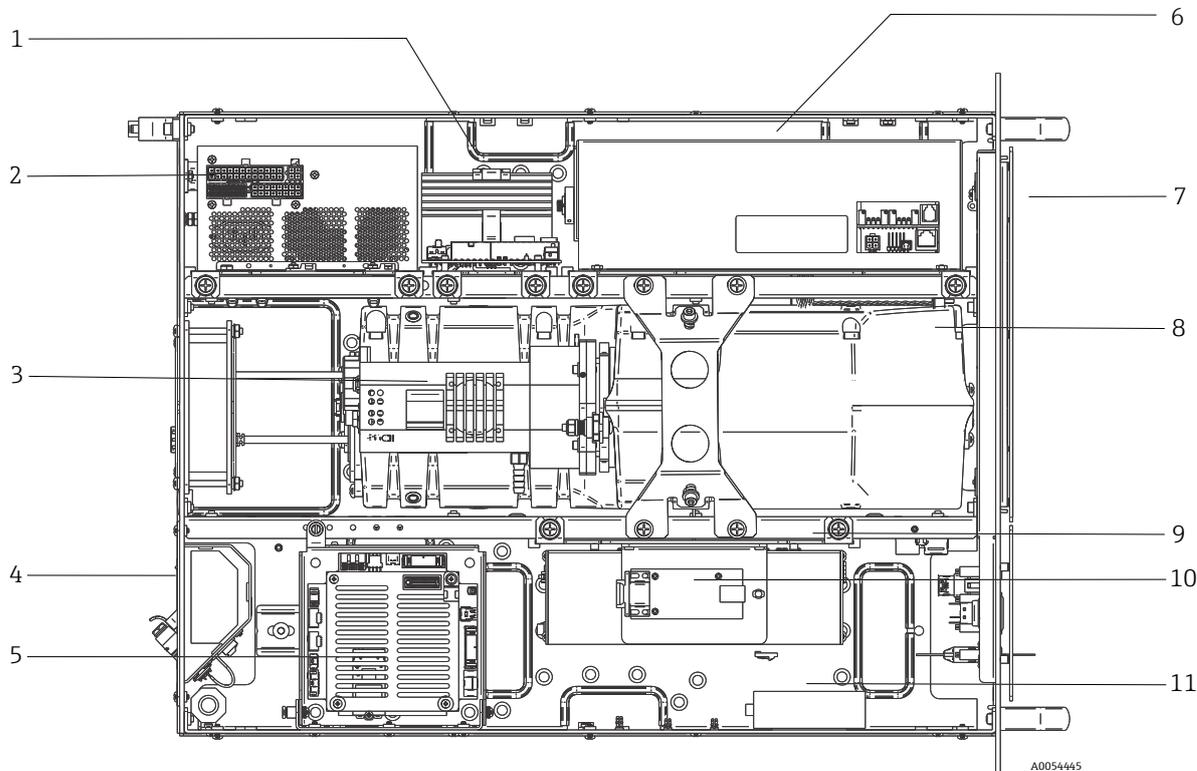
Figura 23: Interior del analizador Raman Rxn4
