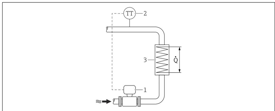
图 17 蒸汽和水热量差值测量示意图
