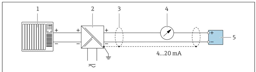
图 5 接线实例：4...20 mA HART 电流输出（无源）
