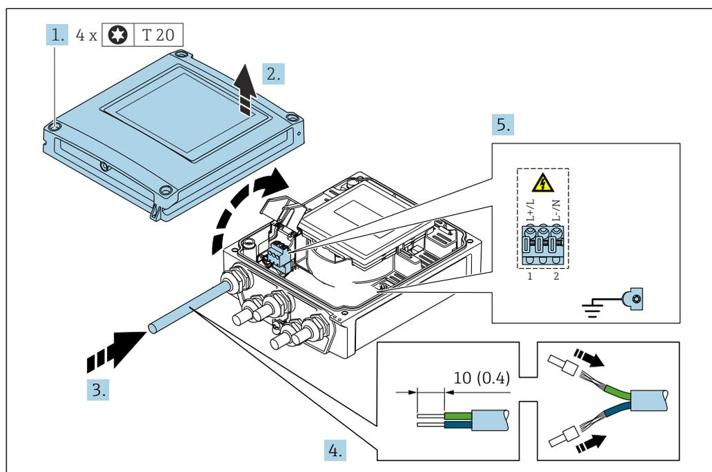
**13** Подключение сетевого напряжения и 0–20 мА/4–20 мА HART с дополнительными выходами/ входами
