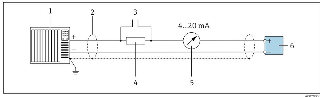
14 Пример подключения токового выхода 4–20 мА HART (активного)
