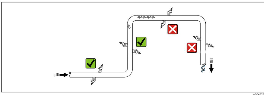
Во избежание погрешностей измерения, проявляющихся в результате скопления газовых пузырьков в измерительной трубе, следует избегать следующих мест монтажа в трубопроводе:
