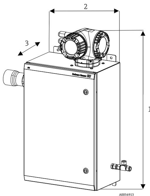
Figura 12. Analizzatore di gas TDLAS J22 con SCS integrato
