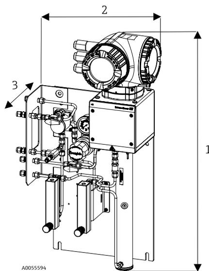
Figura 11. Analizzatore di gas TDLAS J22 con SCS su pannello
