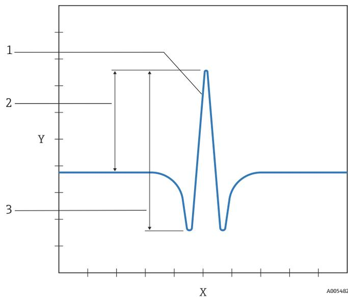
Figura 3. Segnale  $2f$  semplice normalizzato; concentrazione di analita proporzionale all'altezza del picco o all'altezza picco-picco, in base all'algoritmo usato
