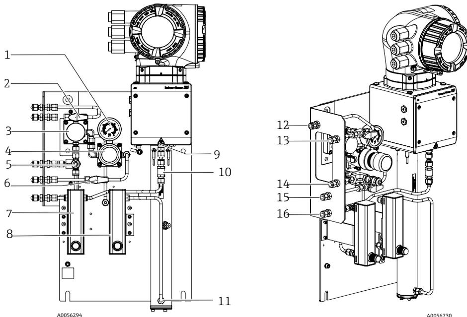
Figura 4. Analizzatore di gas TDLAS J22 con SCS su pannello - allacciamenti del sistema di campionamento e del gas
