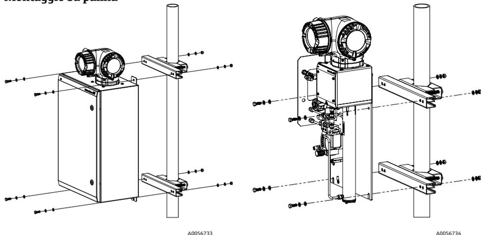
Figura 9. Montaggio su palina dell'analizzatore di gas TDLAS J22 con involucro (sinistra) e su pannello (a destra)
