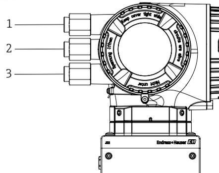
Figura 14. Connessioni del controllore dell'analizzatore di gas TDLAS
