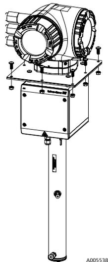
Figura 7. La piastra di montaggio opzionale consente il montaggio in alto dell'analizzatore J22 con involucro fornito dall'utente (non mostrato)
