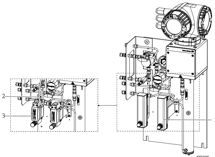
Figura 5. Analizzatore di gas TDLAS J22 su pannello, con misuratori di portata opzionali (2)
