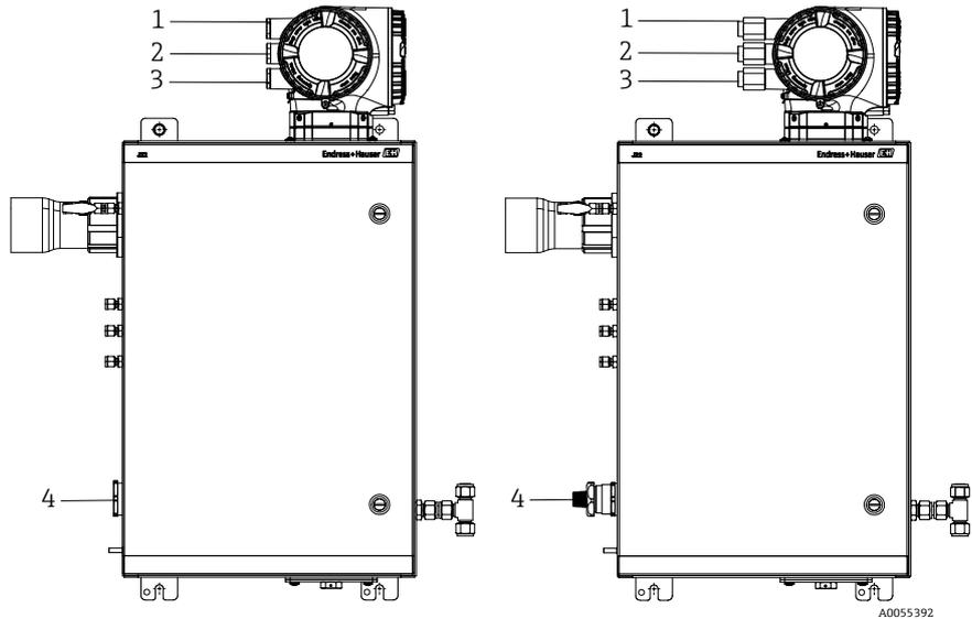
Figura 13. Ingressi filettati dell'analizzatore J22 per involucro per connessioni ATEX (sinistra) e sistema imperiale (destra)
