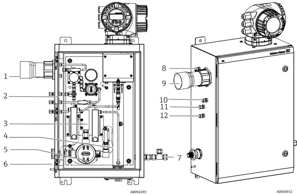
Figura 6. Analizzatore di gas TDLAS J22 con sistema SCS integrato - allacciamenti del sistema di campionamento e del gas
