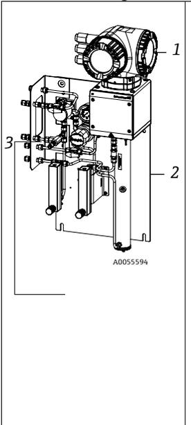
Il sistema dell'analizzatore su un pannello si compone degli elementi indicati di seguito ed è progettato per un montaggio in ambienti esterni vicino al punto di estrazione del campione o all'interno di una struttura di riparo.
