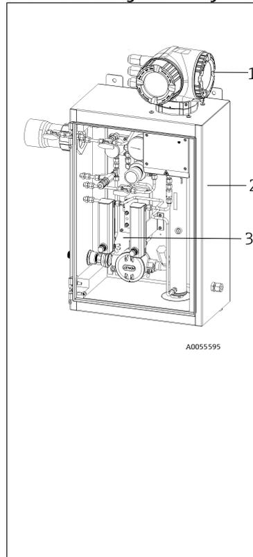
Il sistema dell'analizzatore chiuso con riscaldamento opzionale si compone degli elementi indicati di seguito e viene generalmente usato per il montaggio in ambienti esterni vicino al punto di estrazione del campione.
