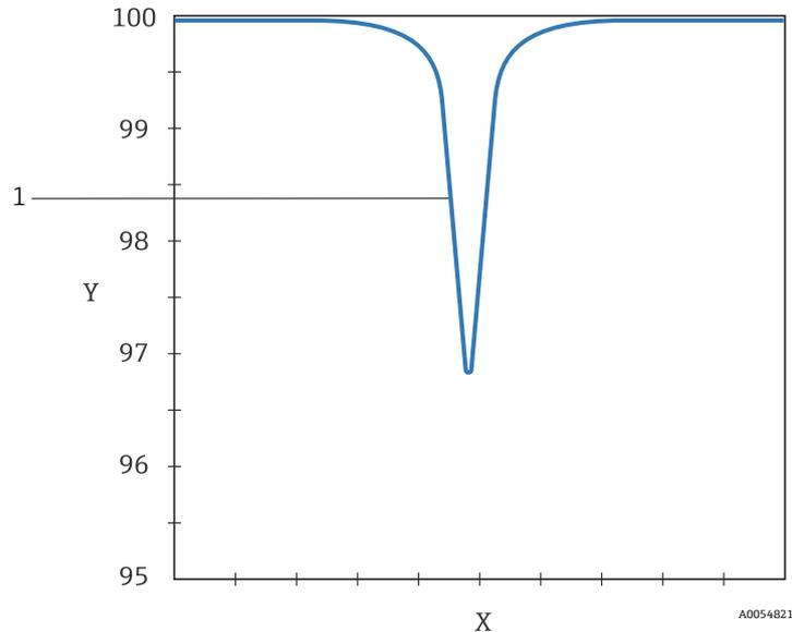
Figura 2. Tipico segnale di assorbimento normalizzato da uno spettrometro ad assorbimento laser con diodo
