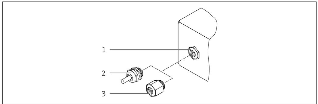
19 Mögliche Kabeleinführungen/-verschraubungen
