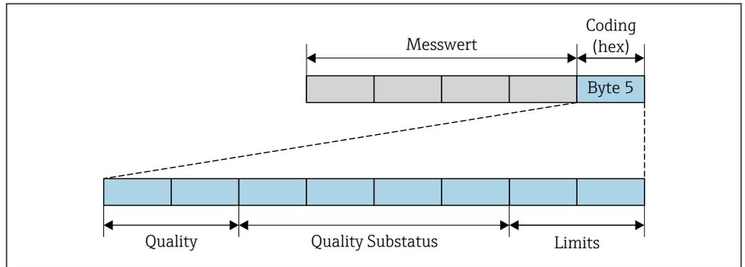
17 Struktur des Coding-Byte
