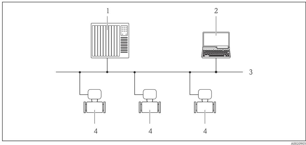
📄 15 Möglichkeiten der Fernbedienung via PROFIBUS DP Netzwerk
