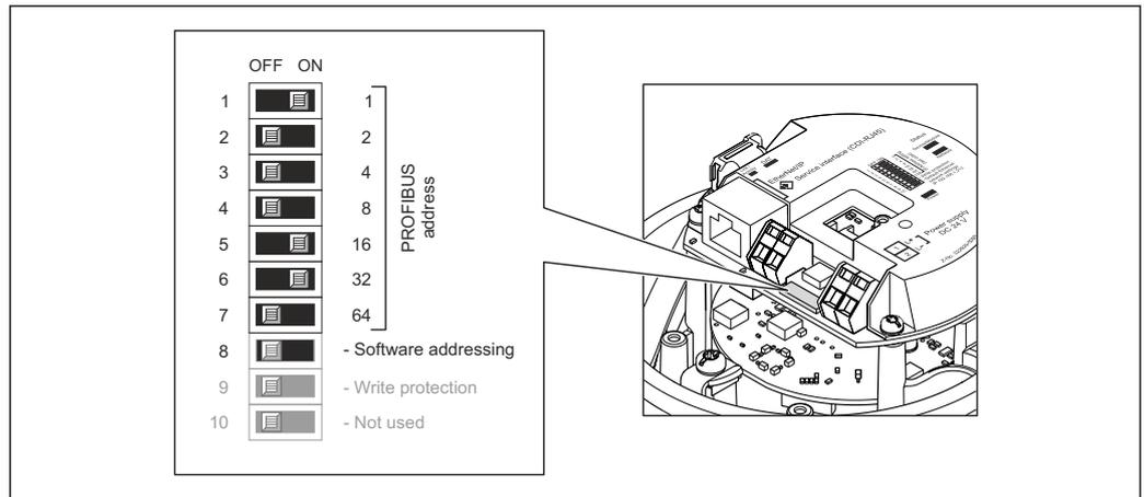
12 Adressierung mit Hilfe von DIP-Schaltern auf dem I/O-Elektronikmodul
