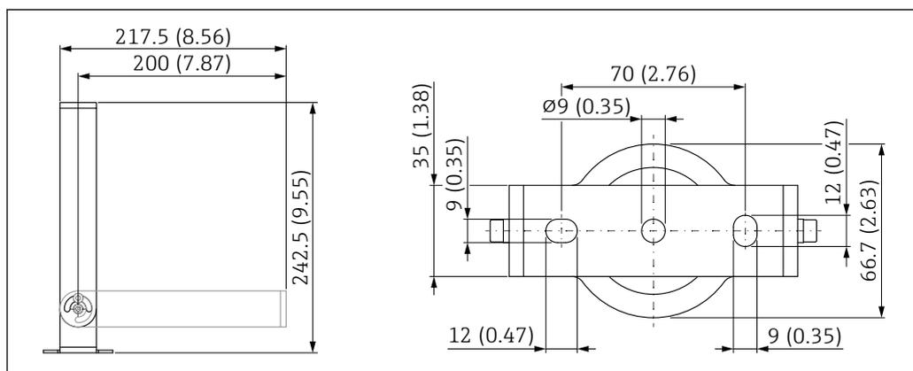
27 Размеры монтажного кронштейна. Единица измерения мм (дюйм)
