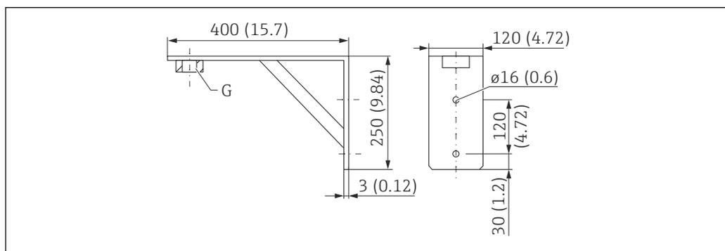
28 Размеры монтажного кронштейна. Единица измерения мм (дюйм)
