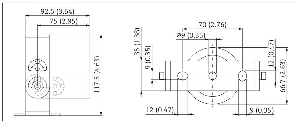
26 Размеры монтажного кронштейна. Единица измерения мм (дюйм)
