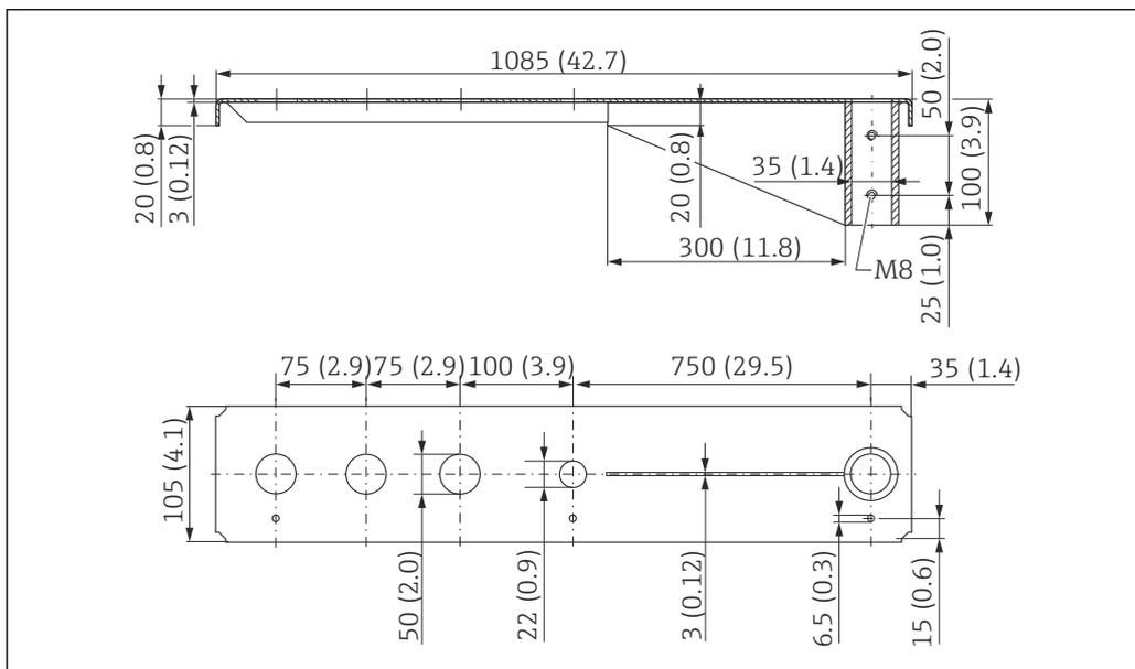
31 Размеры консоли 1 000 мм с шарниром, технологическое соединение на стороне антенны датчика G 1½". Единица измерения мм (дюйм)
