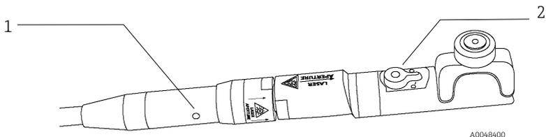
図 2. レーザー放射インジケータおよびレーザー光シャッターの位置
