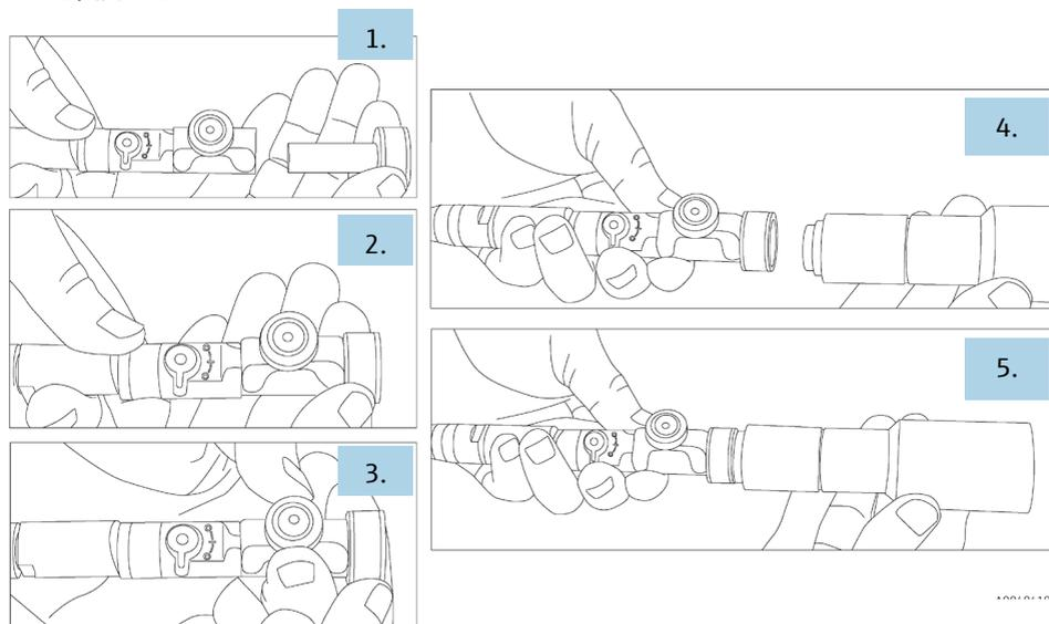
図 11. Rxn-10 プローブへのアダプタおよび非接触式オプティックの取付け
