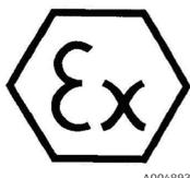
Figure 4. Label ATEX pour l'utilisation en zone explosible
