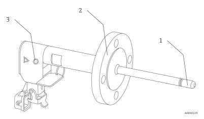
Рисунок 5. Фланцевая конфигурация зонда Rxn-40
