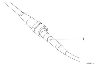
Рисунок 2. Индикатор лазерного излучения (1) на встроенной оболочке из нержавеющей стали для подключения оптоволокна
