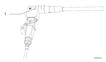
Рисунок 3. Индикатор лазерного излучения (1) на узле углового оптоволоконного разъема  $90^{\circ}$  (тип EO)
