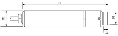
Рисунок 3. Размеры зонда Rxn-20 и адаптера линзы
