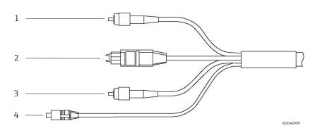
Рисунок 2. Оптоволоконное соединение зонда Rxn-20
