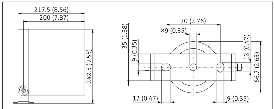
40 Размеры монтажного кронштейна. Единица измерения мм (дюйм)
