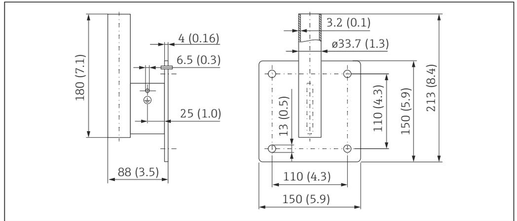
50 Размеры настенного кронштейна. Единица измерения мм (дюйм)
