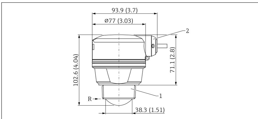
**22** Размеры; антенна 40 мм (1,5 дюйм) с кабельным вводом сбоку. Единица измерения мм (дюйм)
