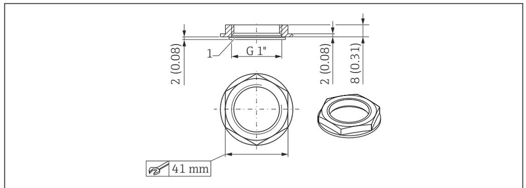
25 Размеры; контргайка, кабельный ввод сверху технологического соединения. Единица измерения мм (дюйм)
