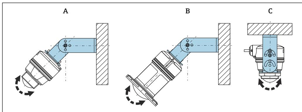
16 Монтаж с монтажным кронштейном, возможность регулировки
