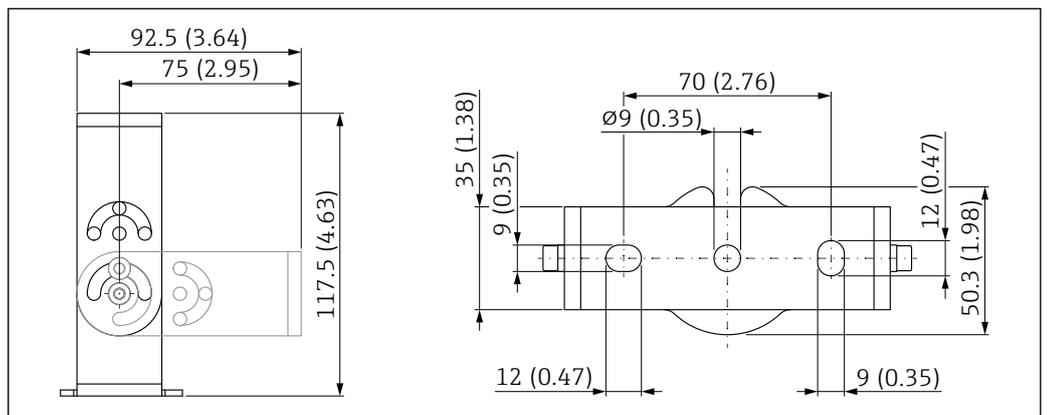
37 Размеры монтажного кронштейна. Единица измерения мм (дюйм)
