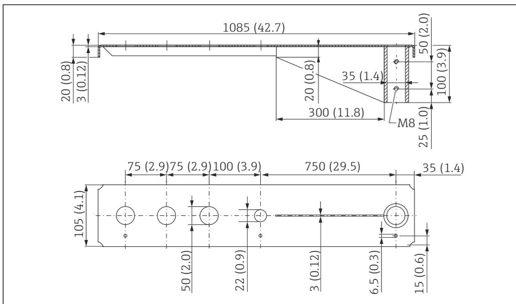
47 Размеры консоли 1 000 мм с шарниром, технологическое соединение на стороне антенны датчика G 1½". Единица измерения мм (дюйм)
