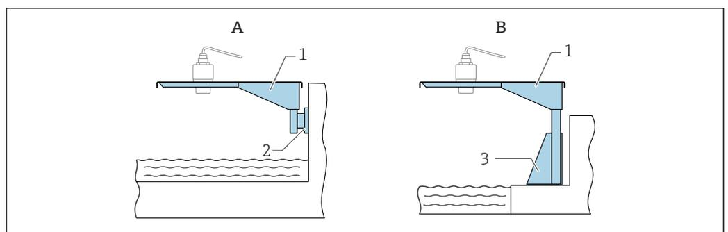
45 Тип монтажа датчика – технологическое соединение со стороны антенны
