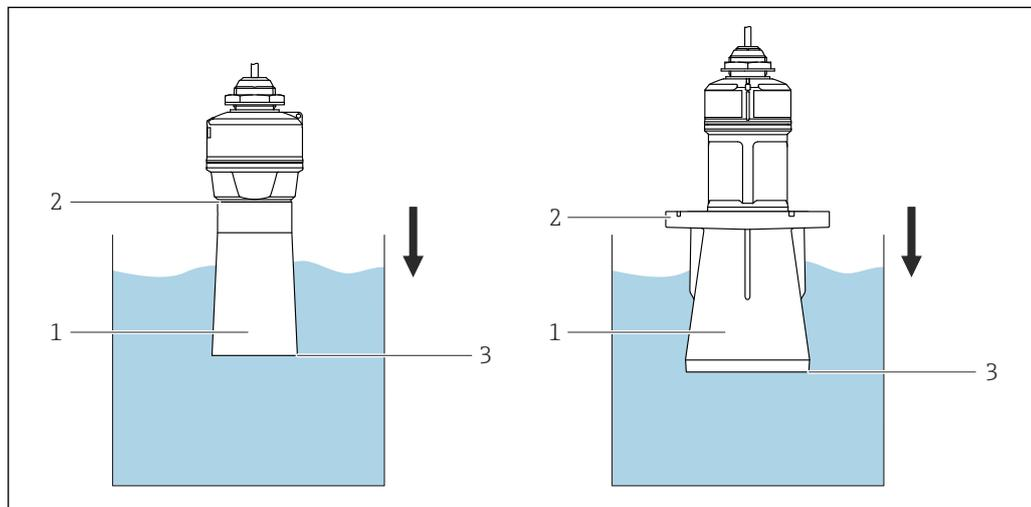
15 Функция трубки для защиты от заполнения водой
