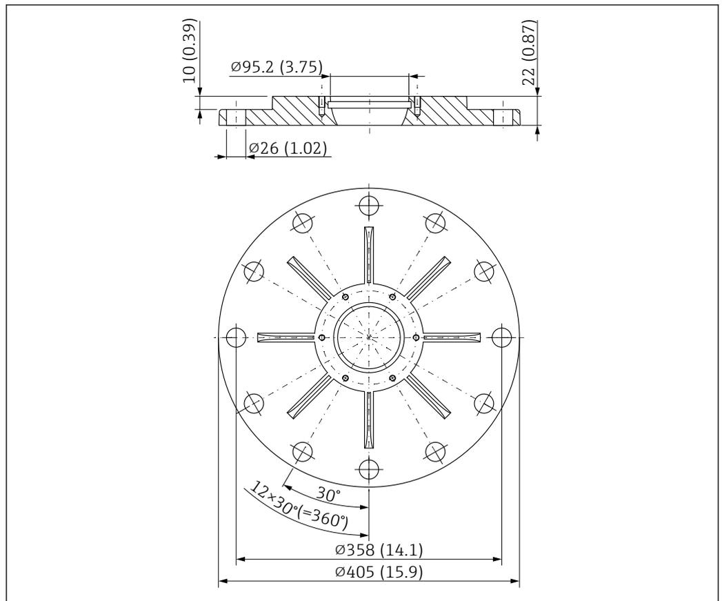
59 Dimensions de la bride UNI 10"/DN250/250A pour antennes avec dispositif d'orientation. Unité de mesure mm (in)
