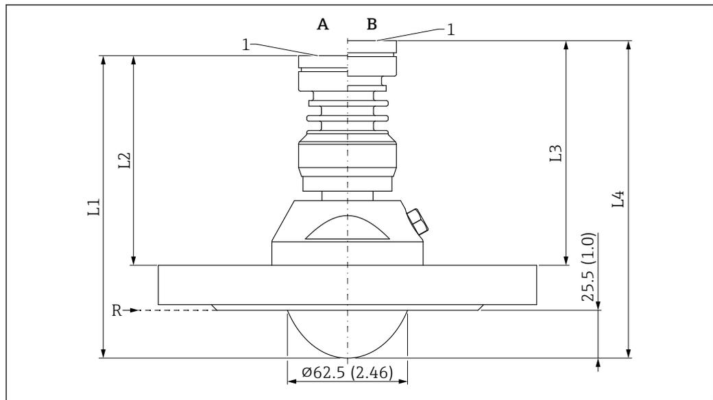
51 Dimensions de l'antenne affleurante, PTFE, 80 mm (3 in), avec bride standard et raccord d'air de purge .
