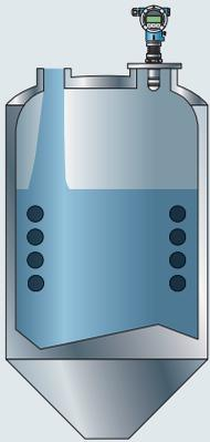
**Behälter mit einstufigem Propellerrührwerk**
