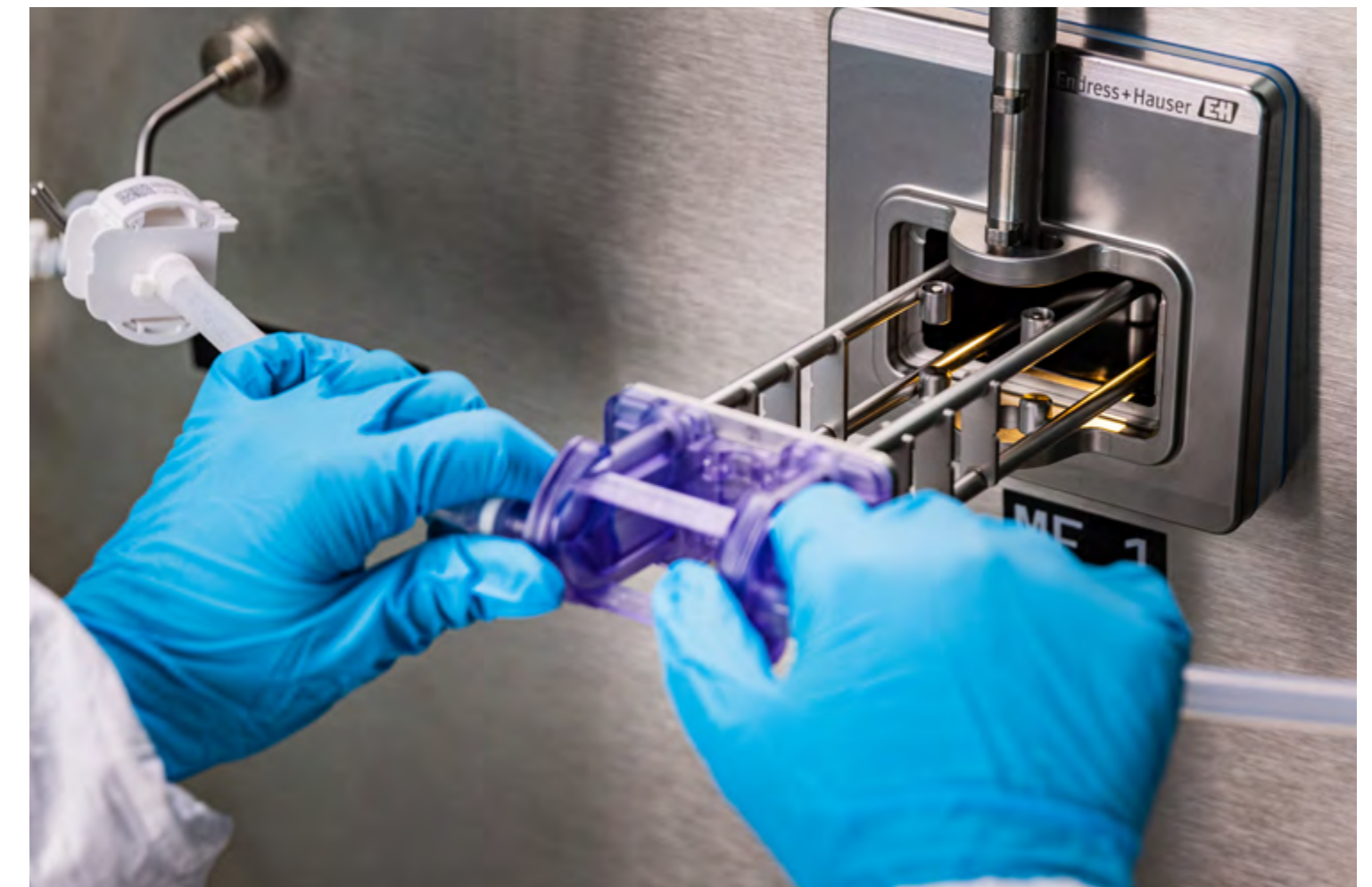
4. Die Kalibrierdaten werden von der Kamera in der Basiseinheit ausgelesen
