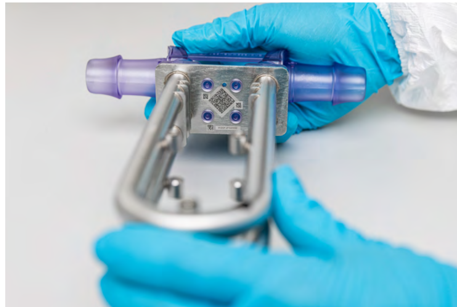
3. Der QR-Code auf dem Einwegteil enthält die Daten der Werkskalibrierung
