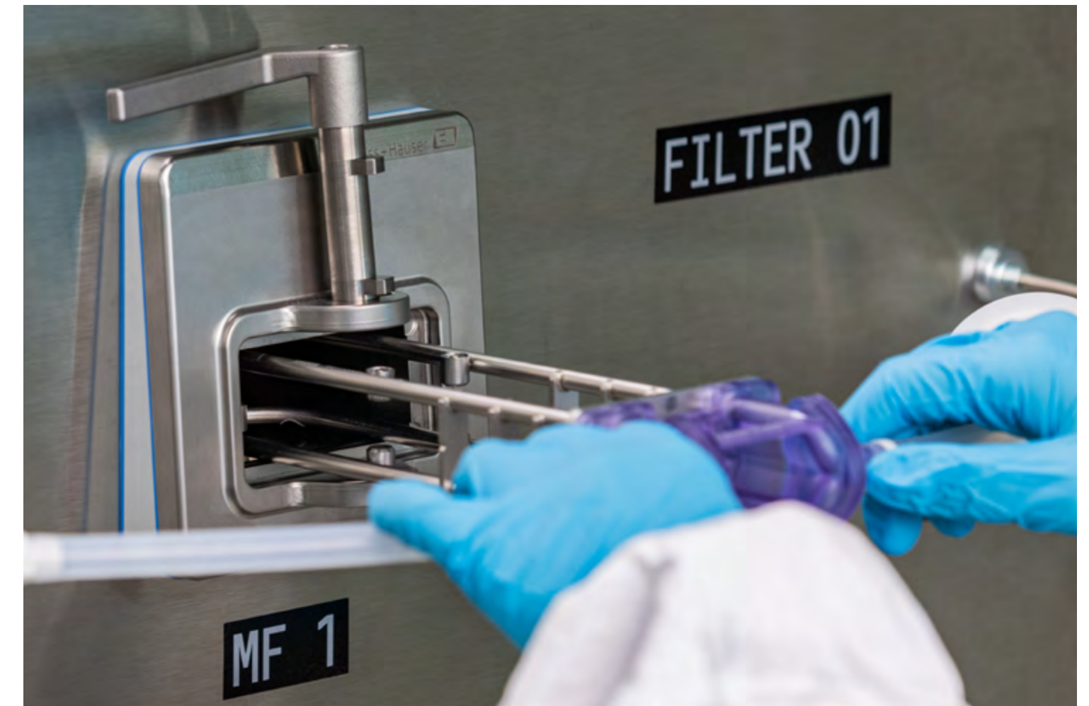
2. Anschließend kann das Einweg-Messrohr entnommen werden
