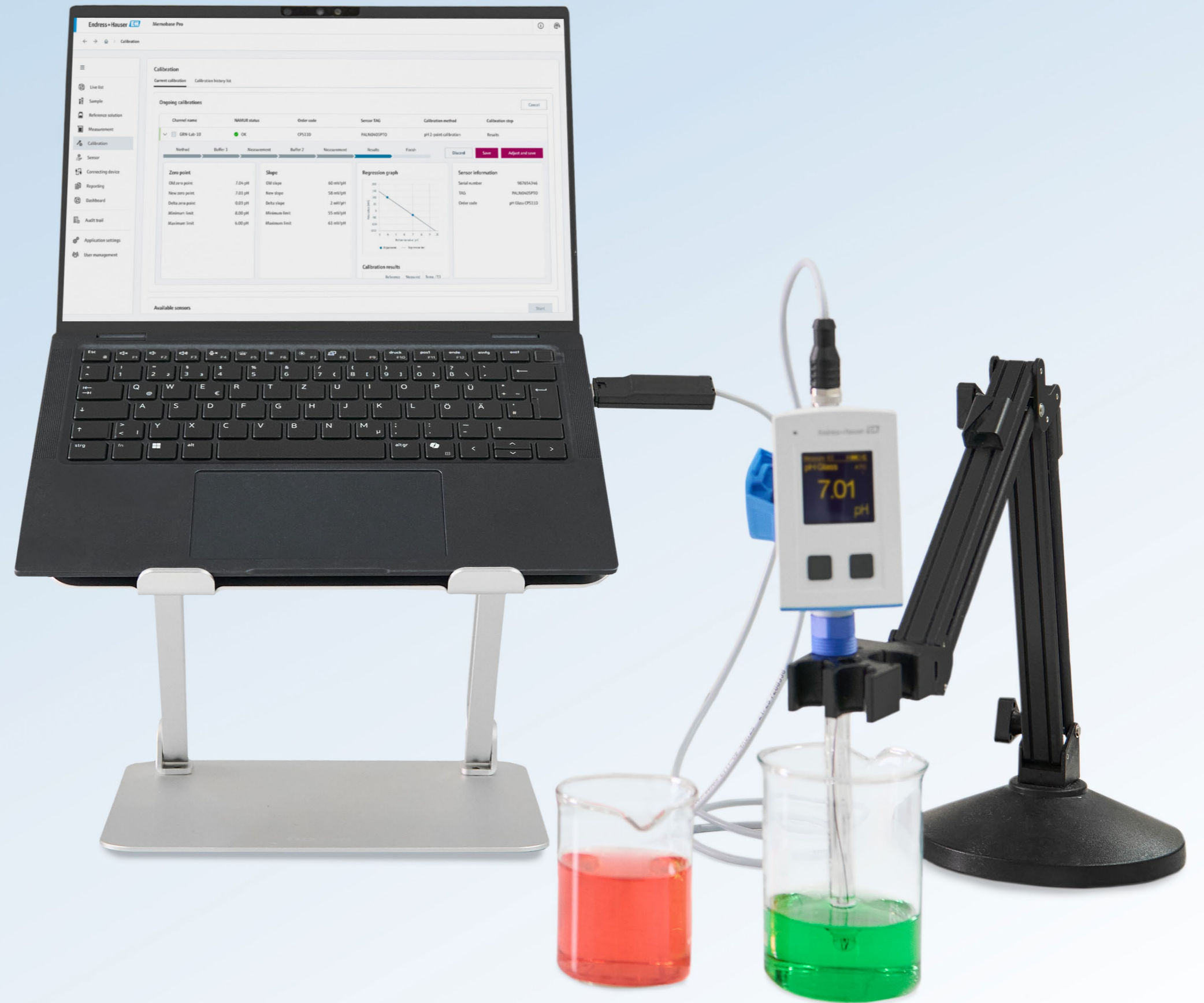
Software Memobase Pro con Liquiline CML18 e misura di pH
