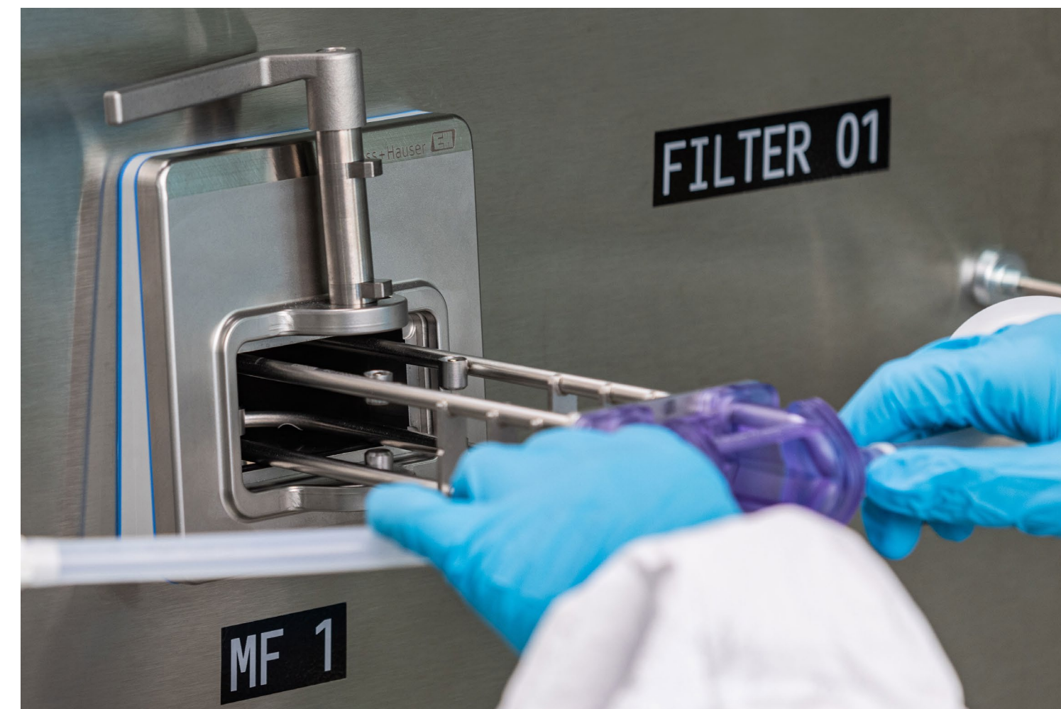
2. Il tubo di misura monouso può quindi essere rimosso
