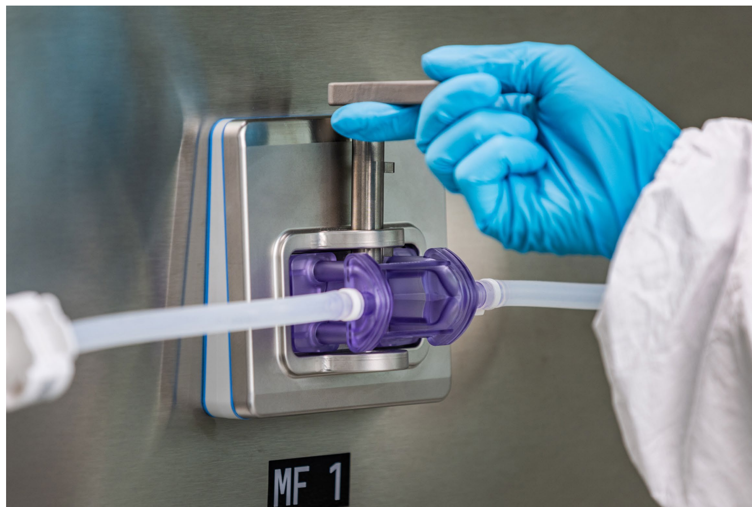
1. Il meccanismo di chiusura può essere facilmente aperto con una sola mano.
