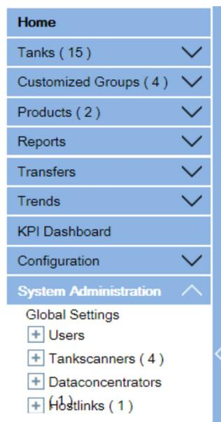
2. Die Abbildung oben zeigt das <Tankvision-Subsystem>, d. h. die Tank Scanner-Einheiten (NXA820), die Data Concentrator (NXA821) und die Host Links (NXA822). Die Tank Scanner-Einheiten, Data Concentrator und Host Links bestehen in diesem Domänen-Netzwerk alle aus NXA820-, NXA821- bzw. NXA822-Einheiten.
