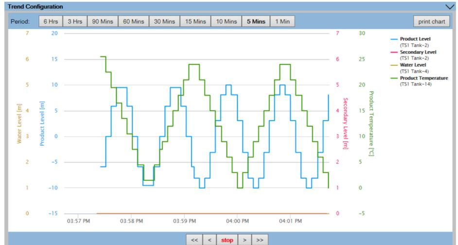
Basierend auf den für die Trendkonfiguration ausgewählten Tankparametern werden die Liniendiagramme angezeigt.
