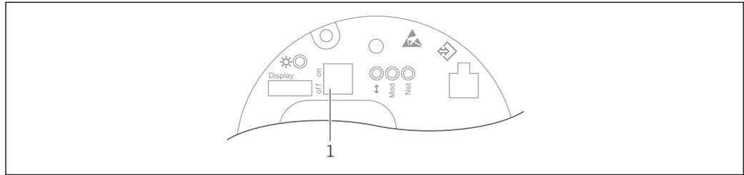
1 DIP-Schalter für Verriegelung und Entriegelung des Geräts
