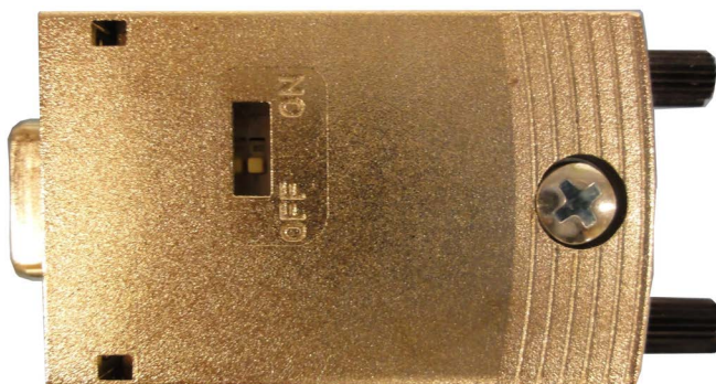
Fig. 10: Connettore con switch a slitta per il resistore di terminazione
