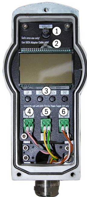
Fig. 11 - Collegamenti elettrici del TRANSIC151LP
