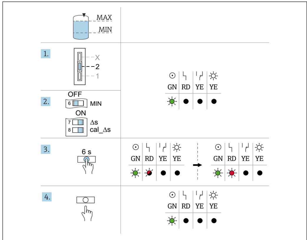
23 Paso 1: Calibración del control a dos puntos  $\Delta s$  (MIN), punto de conmutación superior ajustado
