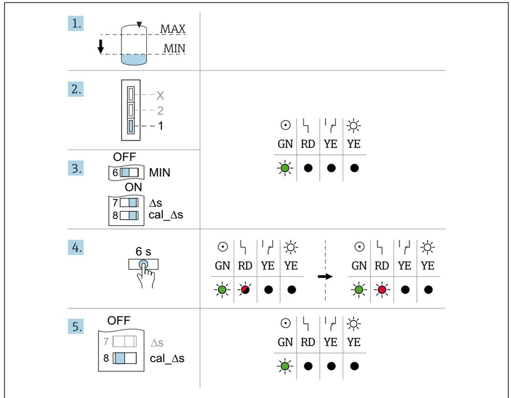
24 Paso 2: Calibración del control a dos puntos  $\Delta s$  (MIN), punto de conmutación inferior ajustado
