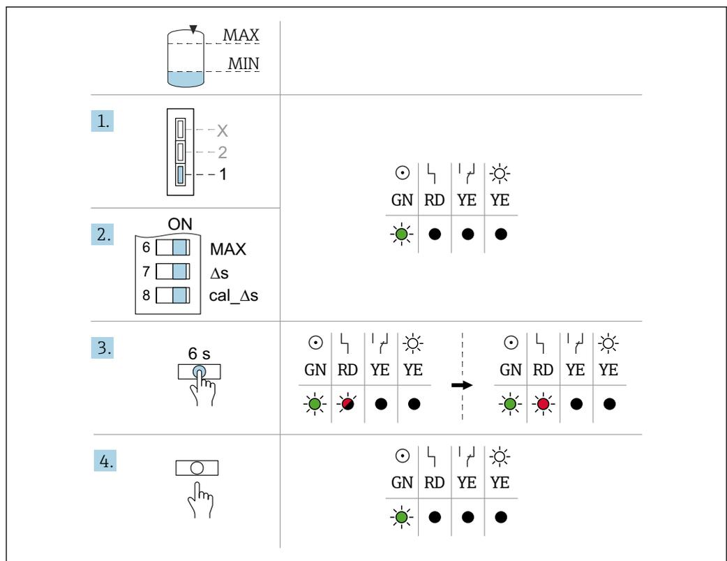
20 Paso 1: Calibración del control a dos puntos  $\Delta s$  (MAX), punto de conmutación inferior ajustado
