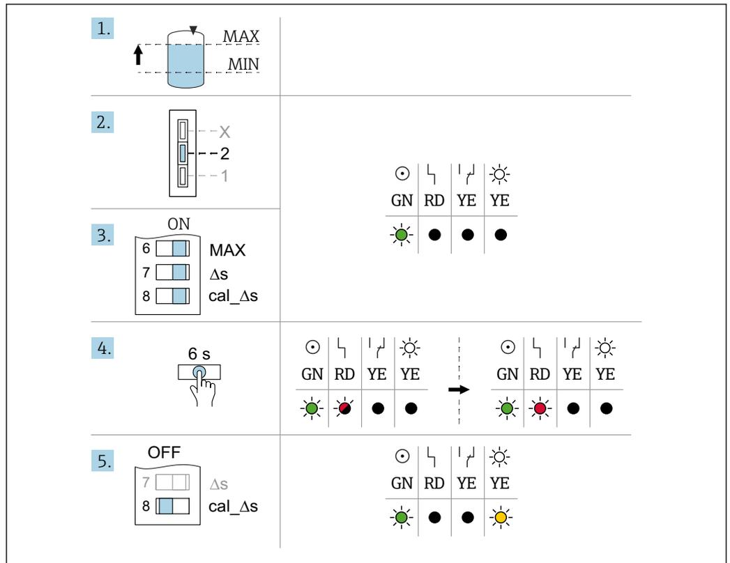
21 Paso 2: Calibración del control a dos puntos  $\Delta s$  (MAX), punto de conmutación superior ajustado
