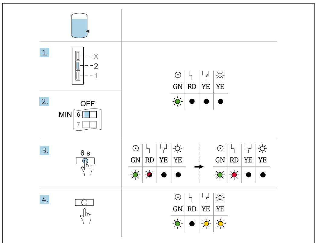
18 Calibración para aplicación MIN
