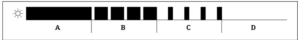
▣ 16 Grafische Darstellung für unterschiedliches Blinkverhalten der LEDs bei der Funktionsauswahl
