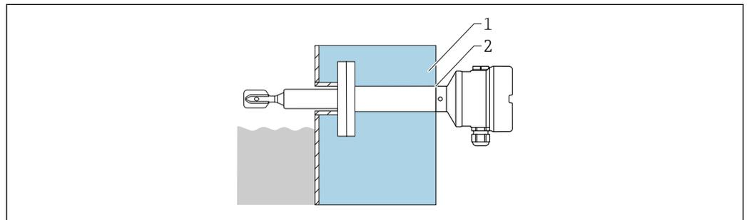
18 Recipiente com isolamento térmico (exemplo com espaçador de temperatura)
