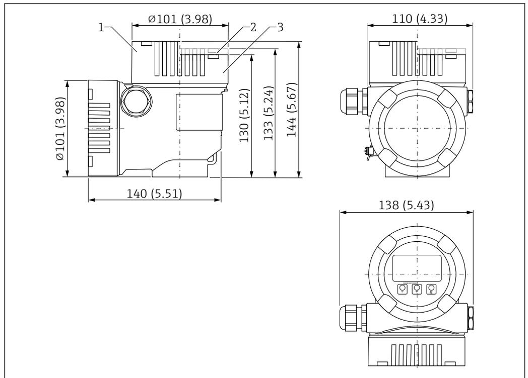
28 Dimensões; invólucro de compartimento duplo em formato de L, 316 L; incl. acoplamento e conector M20, plástico. Unidade de medida mm (in)
