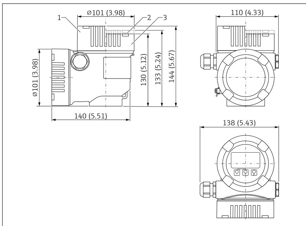
27 Dimensões; invólucro de compartimento duplo em formato de L, alumínio, revestido; incl. acoplamento e conector M20, plástico. Unidade de medida mm (in)
