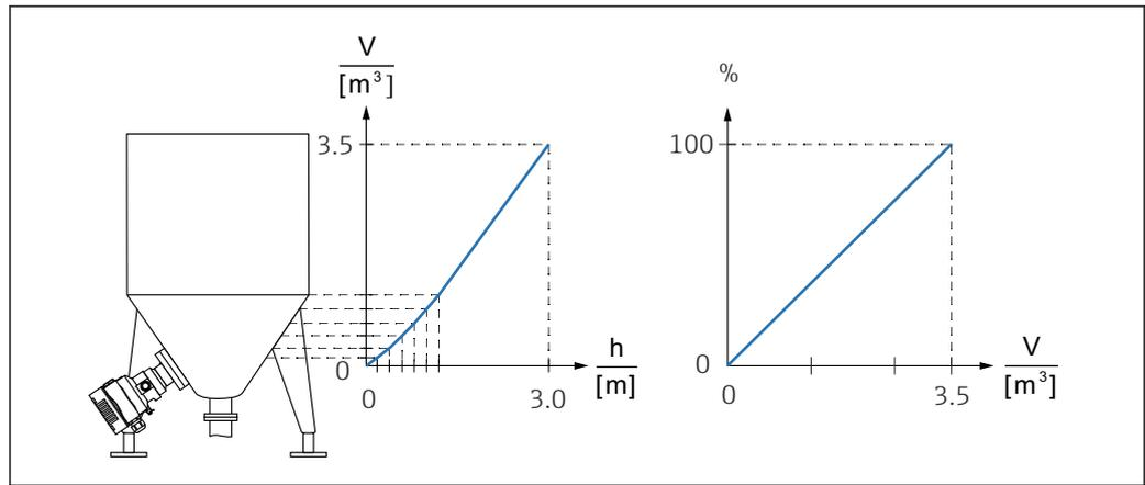
1. La variable mise à l'échelle est communiquée via PROFINET dans le module "Analog Input Scaled Variable", slot 20 (0x1000). Pour utiliser une valeur linéarisée, utiliser le module "Analog Input Scaled Variable".
