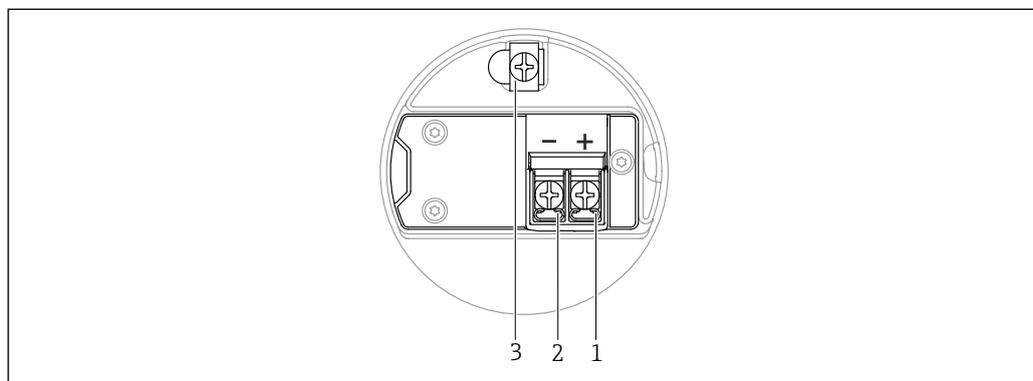
4 Bornes de raccordement et borne de terre dans le compartiment de raccordement
