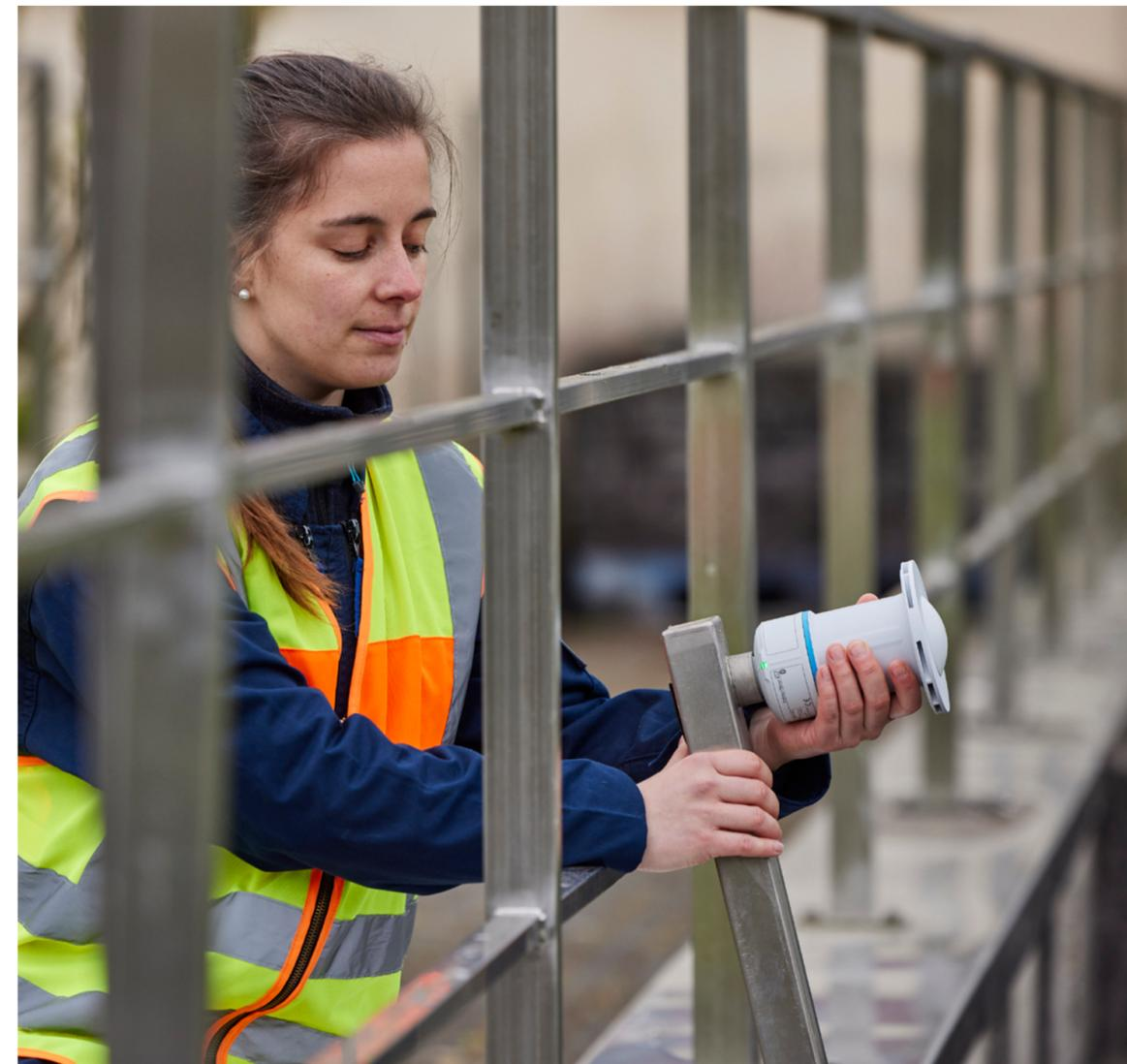
La technologie Heartbeat permet de réaliser une vérification à la demande guidée par l'assistant sans interruption de process. Cette vérification de l'appareil est traçée et documentée et se fait en moins de trois minutes, sans avoir à retirer l'appareil.
