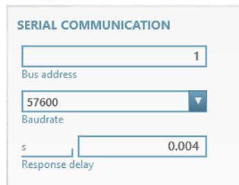
**+i** MODBUS 响应按照在“Response delay”（响应延长）中定义的最小时间间隔进行延迟。该参数可以用于当出现通信故障时对通信速度进行限制。
