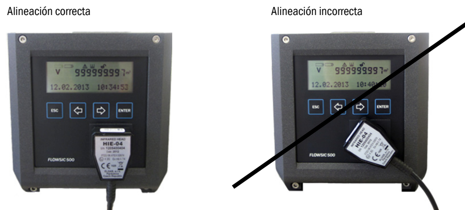
Fig. 37 Alineación del adaptador infrarrojo
