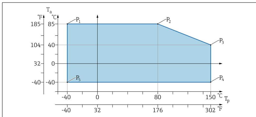
24 Зависимость температуры окружающей среды  $T_a$  от рабочей температуры  $T_p$
