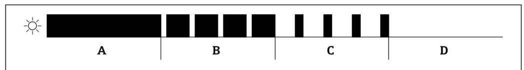
16 Графическое отображение различных состояний мигания светодиодных индикаторов при выборе функции
