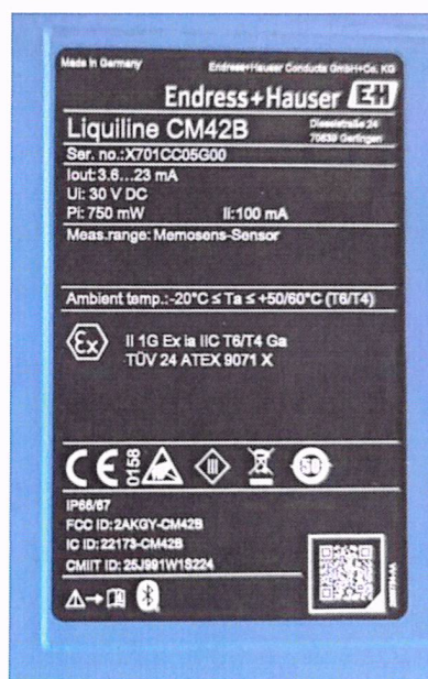
Рисунок 2. Маркировка преобразователя Liquiline CM42B
