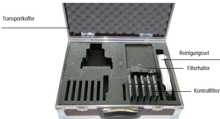
Abb. 14: Komponenten des Linearitätsprüfmittels
