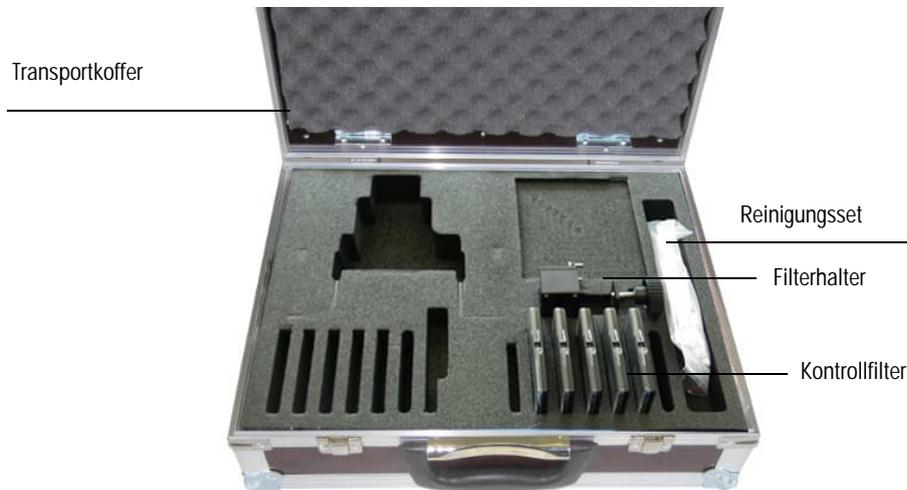
Abb. 5: Komponenten des Linearitätsprüfmittels
