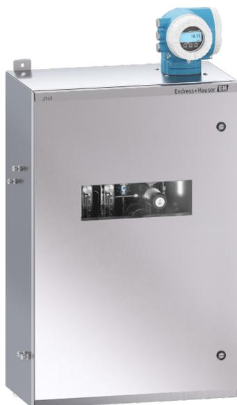
図2: Endress+Hauser JT33 TDLASガスアナライザは、差分分光技術を使用して、アミン処理装置の流出口ガストリームのH<sub>2</sub>S(低ppbからppmレベル)を定量化します。
