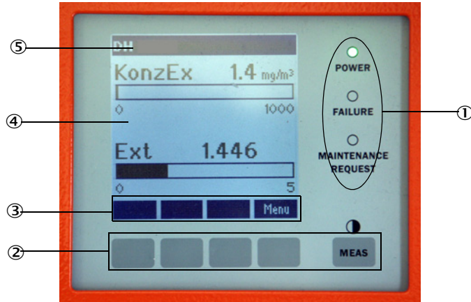
Res. 46: LSD ekranı fonksiyon elemanları
