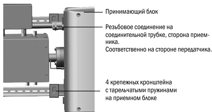
Рис. 16: Соединительная трубка, сторона приемника
