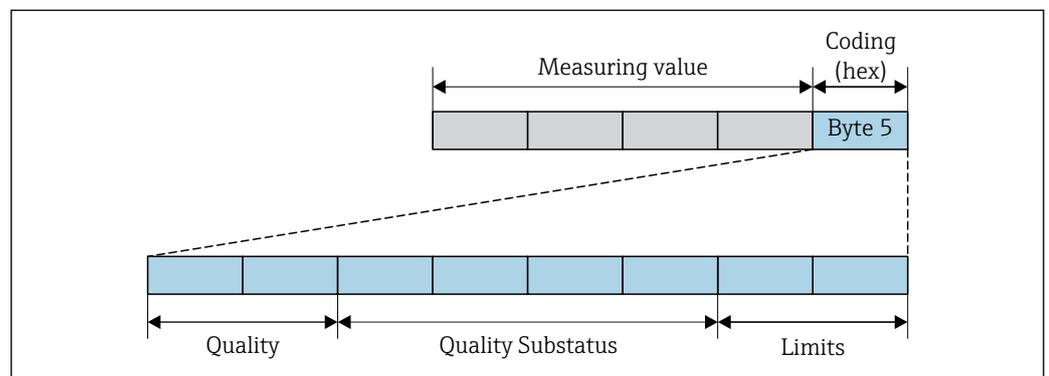
14 Struttura del byte di stato
