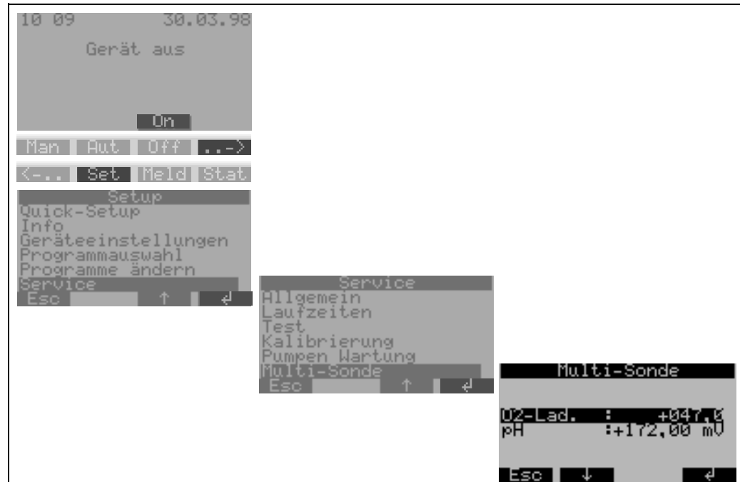
Abb. 21: Kontrolle der pH-Messung (Sensor-Check-System)
