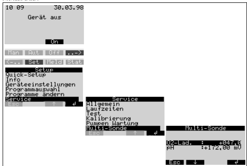
Abb. 22: Kontrolle der Sauerstoffmessung (Sensor-Check-System)
