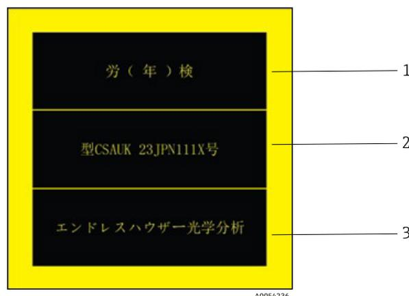
Abbildung 8. JPEX-Kennzeichnung für den Einsatz in explosionsgefährdeten Bereichen
