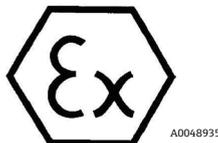
Abbildung 6. ATEX-Kennzeichnung für den Einsatz in explosionsgefährdeten Bereichen
