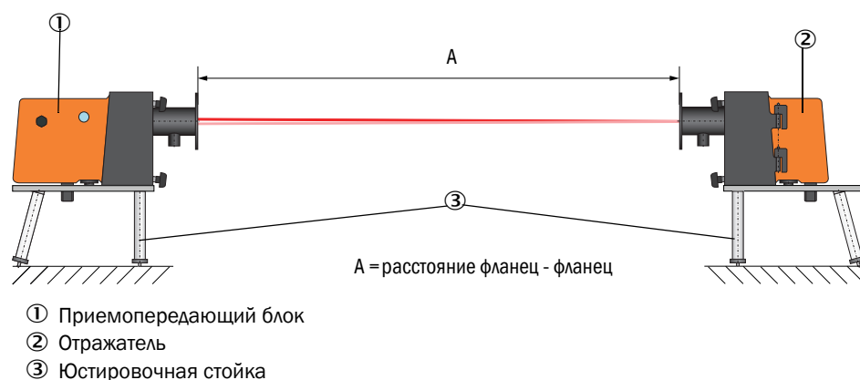
Рис. 35: Установка на свободном от пыли участке с юстировочными стойками (изображение для DUSTHUNTER T100)
