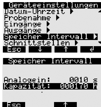
Abb. 32: Aktivierung des internen Data-Loggers
