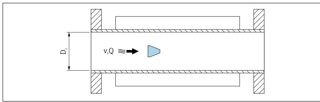
D<sub>i</sub> 测量管内径 (对应尺寸 K)
