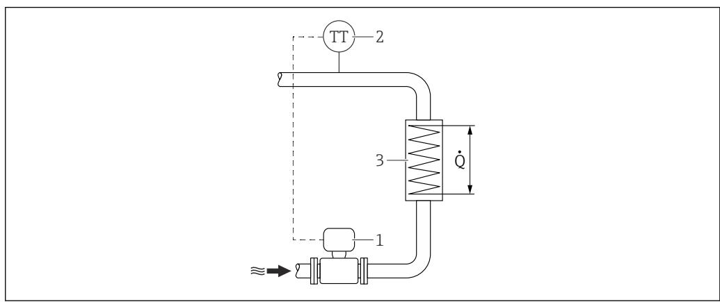
图 6 蒸汽和水热量差值测量示意图
