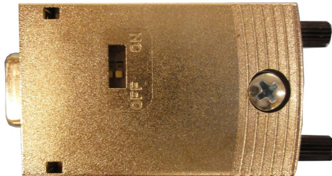
Afbeelding 10: Stekker met schuifschakelaar voor eindweerstand
