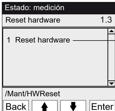
En este menú se inicia el restablecimiento del hardware (equivalente a: tensión de alimentación conectada/desconectada).
