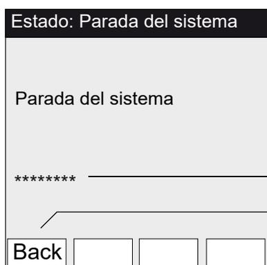
Desactivación de la función de medición y (si hay) de la periferia de extracción de gas (válvulas, bombas). La función del equipo permanece (p. ej.: las calefacciones siguen funcionando).
