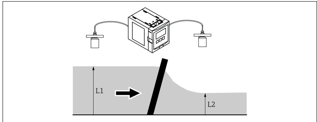
図 65 スクリーン制御機能の動作原理
