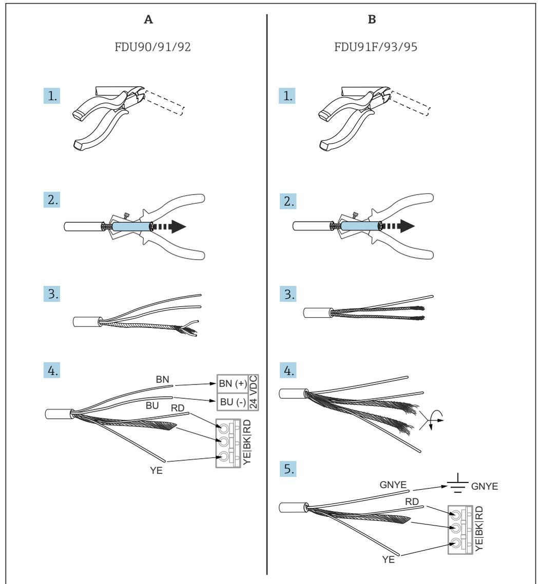
図 29 センサケーブルの切断
