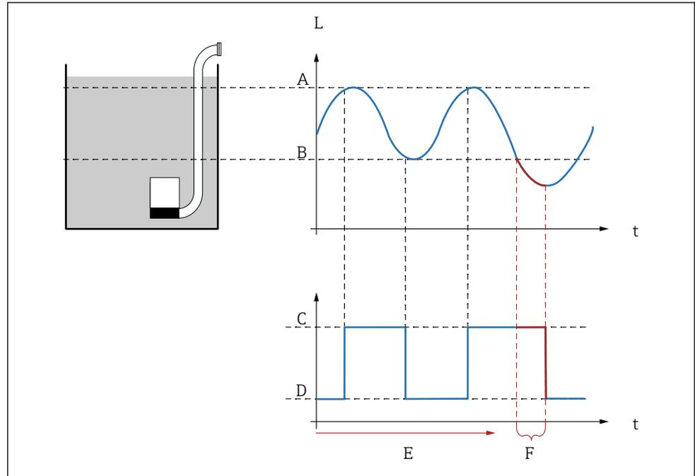
図 62 「反動間隔」および「反動時間」の影響
