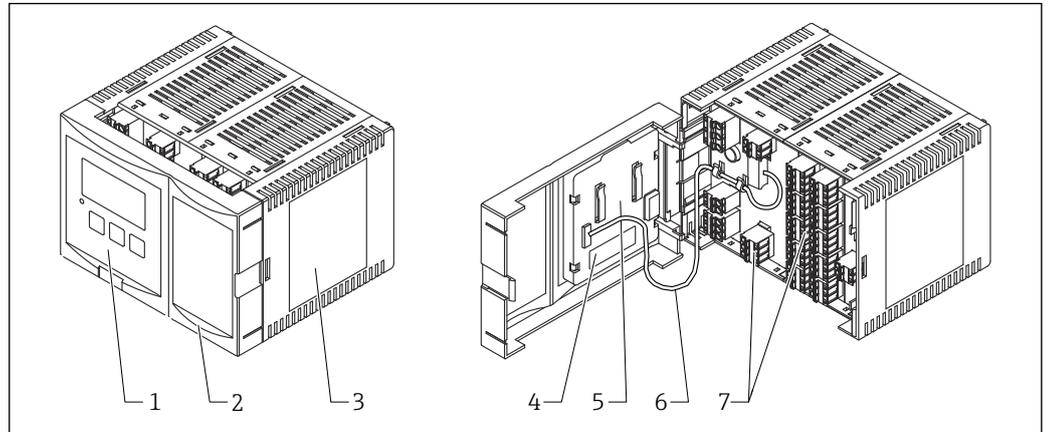
図 3 DIN レールハウジング内の Prosonic S の各部品
