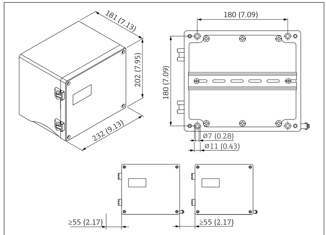
図 9 アルミニウム製フィールドハウジング付き Prosonic S の寸法。測定単位 mm (in)
