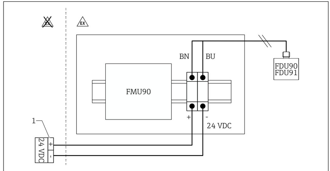
図 31 アルミニウム製フィールドハウジング内のセンサヒーターの接続
