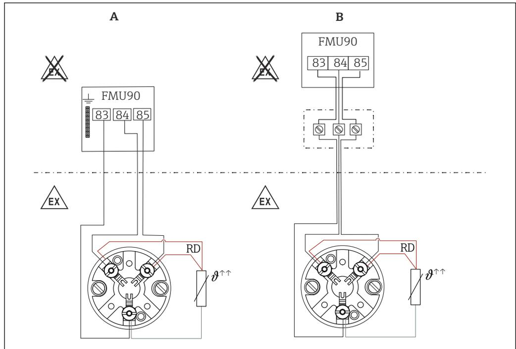
図 38 危険場所での Omnigrad S TR61 の接続
