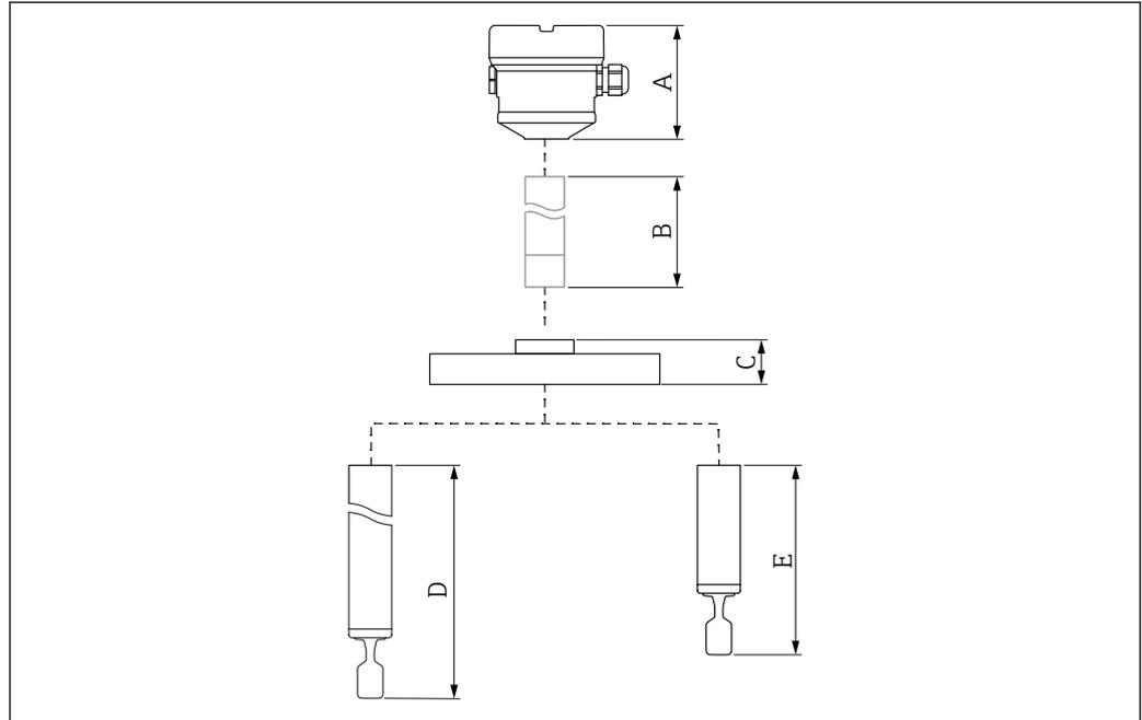
图 23 计算设备高度所需考虑的部件
