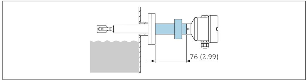
图 29 隔爆玻璃馈通（搭配延长管使用）。测量单位 mm (in)
