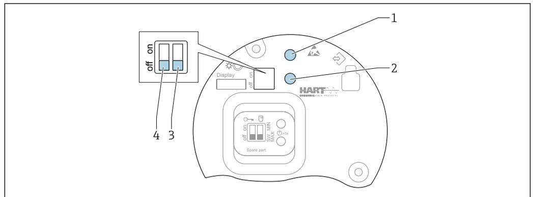
图 34 FEL60H 电子插件上的操作按键和 DIP 开关
