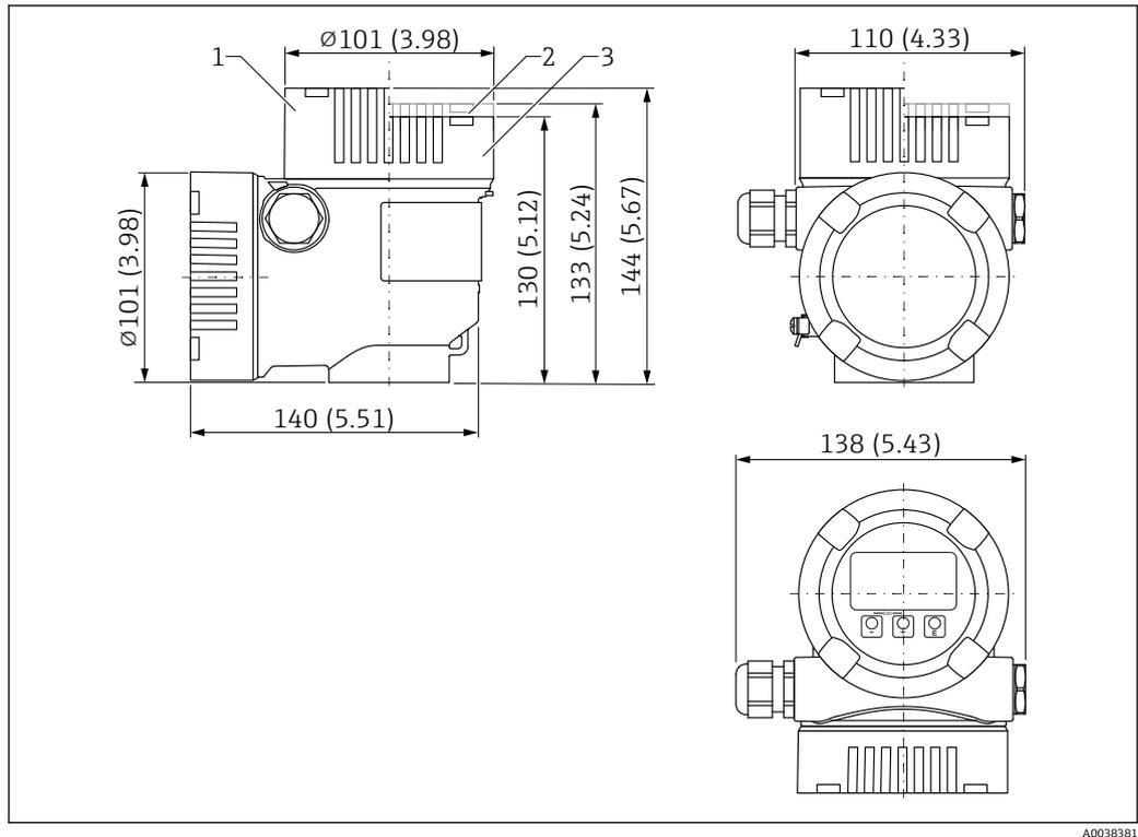
图 28 L 型双腔室 316L 外壳的外形尺寸示意图；包括 M20 接头和塑料插头。测量单位 mm (in)
