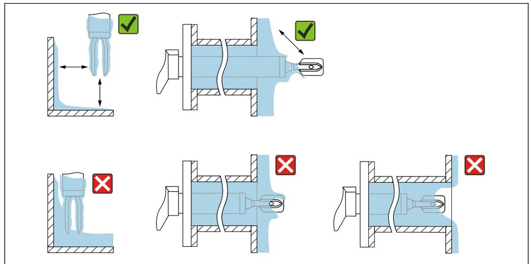
图 12 安装实例：测量高粘度过程介质
