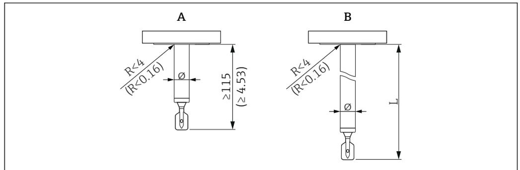
图 30 探头类型：短管型，延长管型。测量单位 mm (in)
