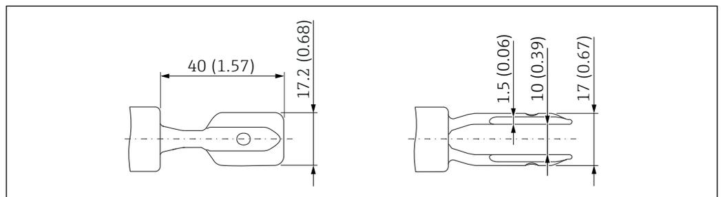
图 31 音叉，带塑料涂层 (ECTFE、PFA)。测量单位 mm (in)
