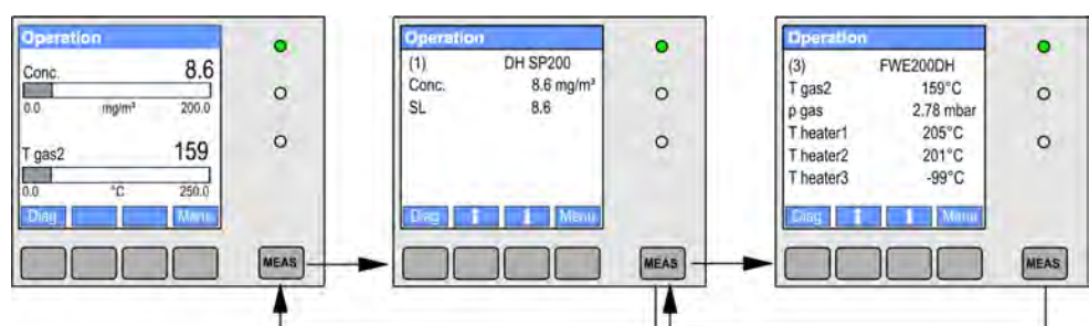
Display LCD con visualizzazione grafica (a sinistra) e come testo (al centro e a destra) (esempio)
