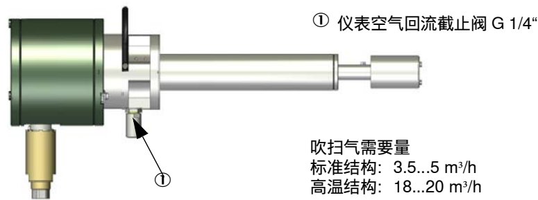
图 27: 收发单元上的吹扫气供应接头
