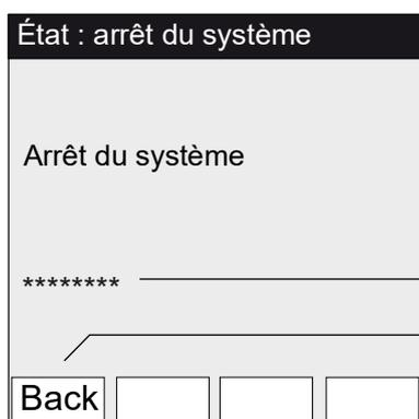
Arrêt de la fonction de mesure et, s'il y en a, des périphériques de prélèvement du gaz (vannes, pompes).
