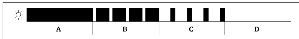
図 17 機能が選択されたときの LED のさまざまな点滅状態のグラフィック表示
