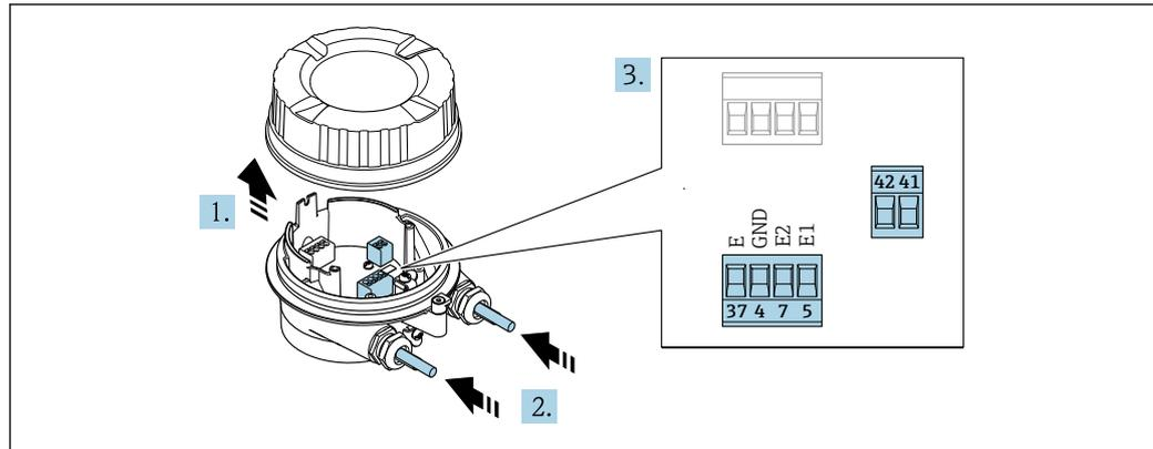
12 Sensore: modulo di connessione
