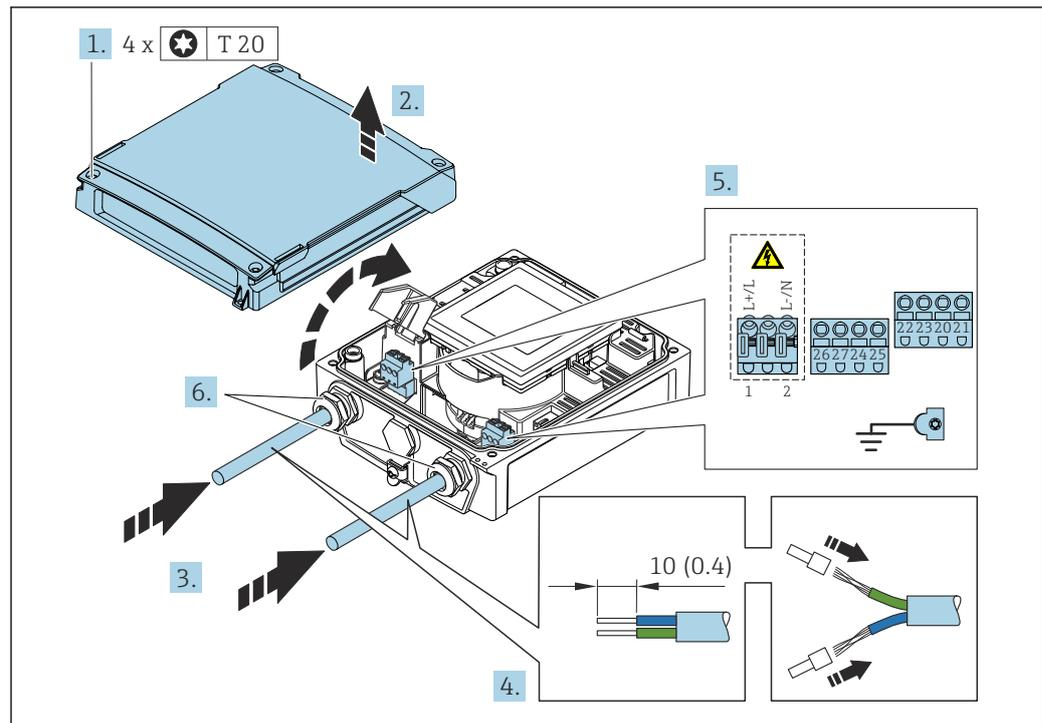
14 Connessione della tensione di alimentazione
